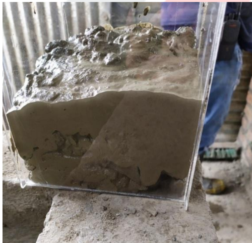
Figura 100. Prueba Presión Lateral. Fuente propia.
