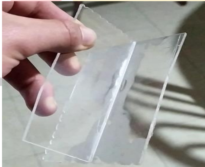
Figura 91. Aplicación del pegamento S-320 para realizar la unión. Fuente propia.
