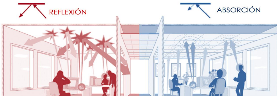
Ilustración 64 Reflexión y absorción del sonido. (ABSORTEC, 2019)
