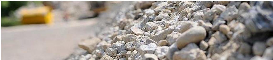
Imagen 22, Agregado de concreto reciclado. Fuente: <https://civilgeeks-com> 2017
