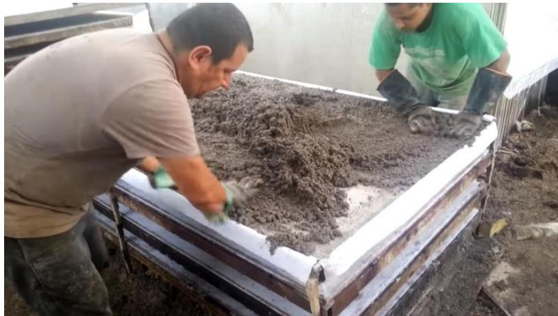
Imagen 35, Elaboración de un panel de fibrocemento Fuente: <https://www.youtube.com/watch?v=BdEyS4naqs> 2018
