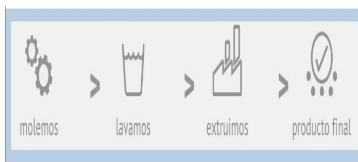
Ilustración 54. Proceso de producción de pellets. Fuente: https://dspace.ups.edu.ec/bitstream/123456789/10270/1/UPS-GT001304.pdf 2015
