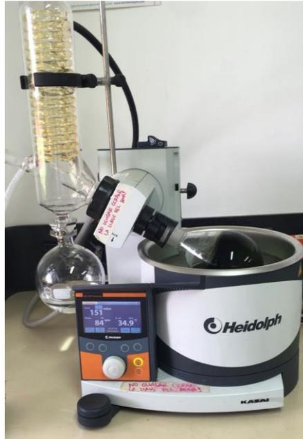
**Figura 15.** Proceso de Rota evaporación
