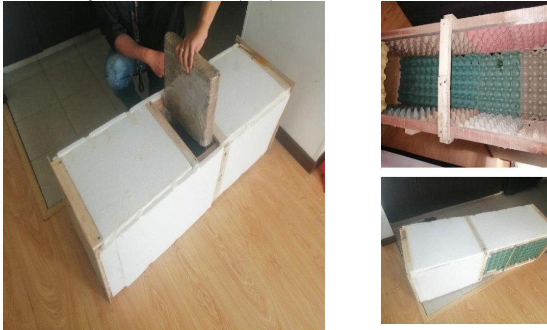
Figura 52. Detalle del túnel para prueba absorción sonido.
