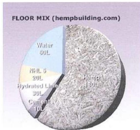
Ilustración 60. Dosificación para la fabricación de Hempcrete (Allin, 2012)
