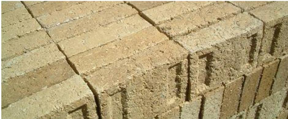
Ilustración 51. Ladrillos de Cannabric, hechos con fibra de cáñamo (CANNABRIC, 2009)
