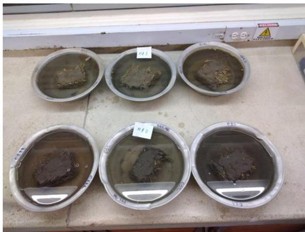
Ilustración 88. Prueba de absorción de agua (Fuente, Autor)
