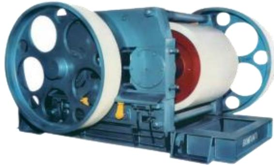
Ilustración 90. Molino refinador seco y húmedo (Romo, 2013)
