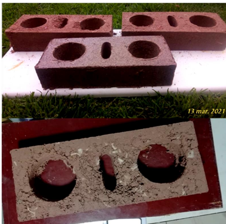
Figura 103. Ladrillos EcoUrban N°6, fabricados con molde de acero.
