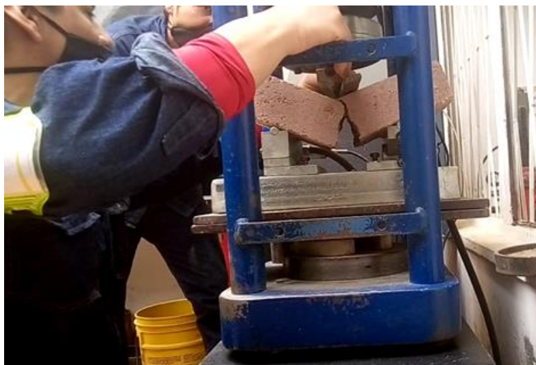
Figura 112. Ensayo, resistencia a flexión, ruptura del ladrillo
