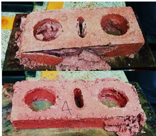
Figura 106. Ensayo resistencia a compresión, falla; aplastamiento del ladrillo.
