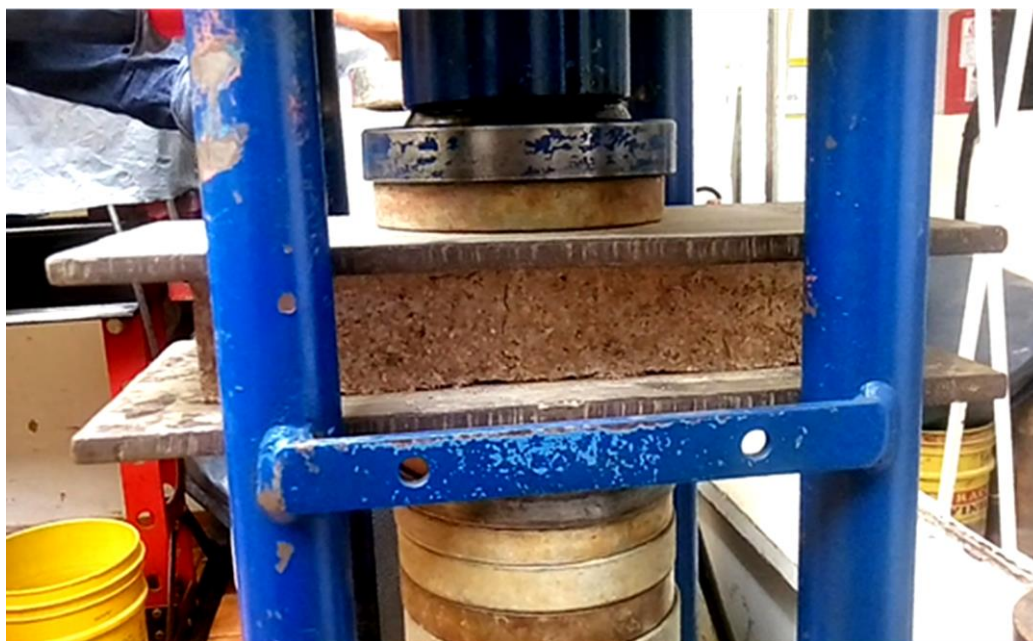
Figura 105. Ensayo resistencia a compresión, falla; fisura del ladrillo.
