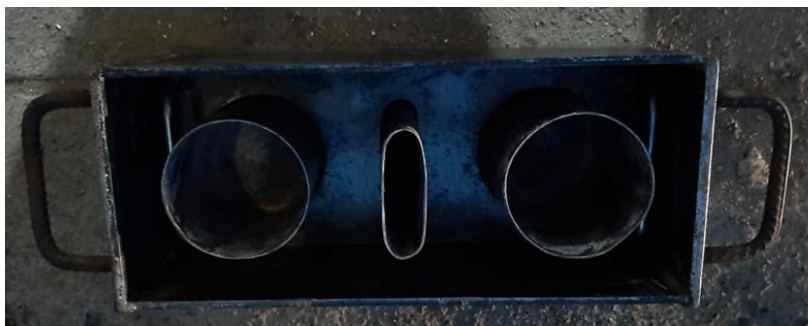
Figura 102. Molde de acero para fabricación de prototipo del ladrillo EcoUrban N°6.
