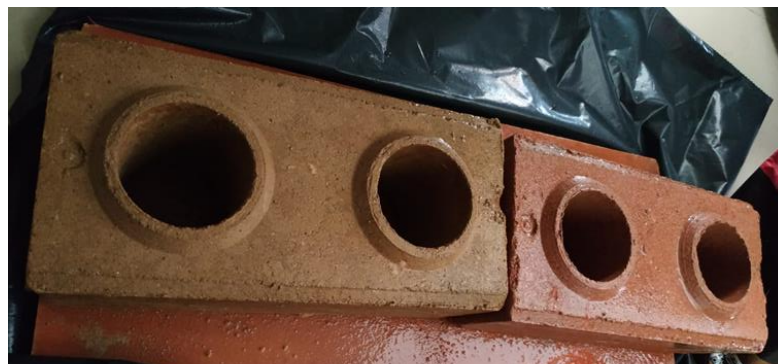
Figura 101. Ladrillos EcoUrban N°6, fabricados con la prensa hidráulica
