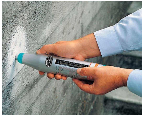
Figura 78. Ensayo Esclerométrico o Índice de Rebote
