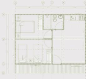
**VI-MO.P** Es una vivienda prefabricada de madera, compuesta de paneles armados (panel 1.22mx2.44m) desarrolla en sistema constructivo palafítico (sistema para zonas inundables). La unidad básica está compuesta de paneles armados (panel 1.22mx2.44m), conformando módulos de 2.44mx2.44m. La vivienda es en madera Inmunizada, con dotación básica de aparatos sanitarios, Kit red eléctrica, Kit red hidrosanitaria.
