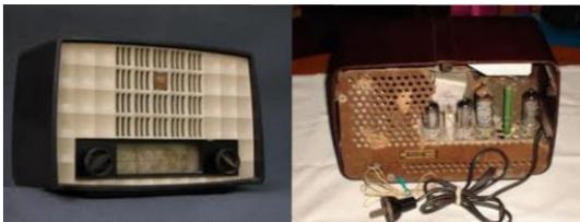
**Figura 3.** Radio de tubos Philips, vistas frontal y posterior.
