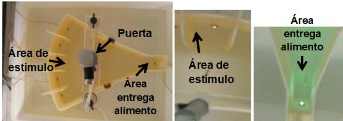
Figura 5: Instrumento utilizado en el ensayo de 5-C5RTT. Se muestra el equipo utilizado para determinar el déficit de atención e impulsividad en el Pez cebra, está dividido en dos áreas, un área de entrega de alimento con una luz led verde y un área de estímulo con 5 luces led amarillas.
