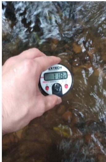
Figura 13. Medición de la temperatura por medio termómetro digital Exttech Instruments.
