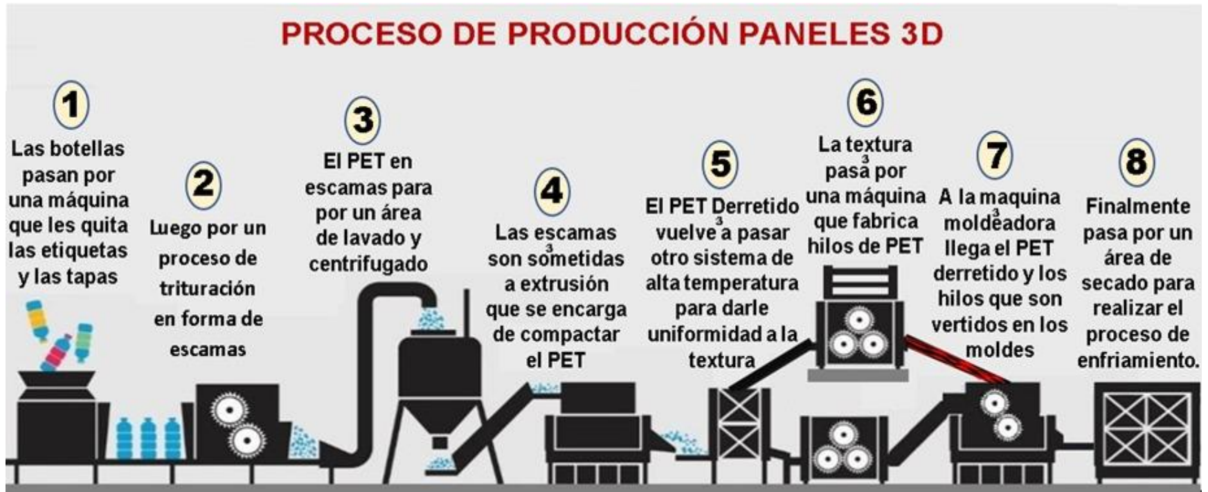
Figura 74 Proceso productivo de los paneles 3D
