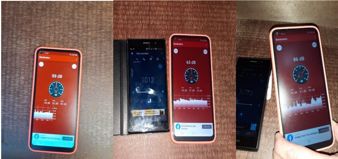
Figura 42 Decibeles y frecuencias en caja inzonorizada de 50x50 sin el prototipo
