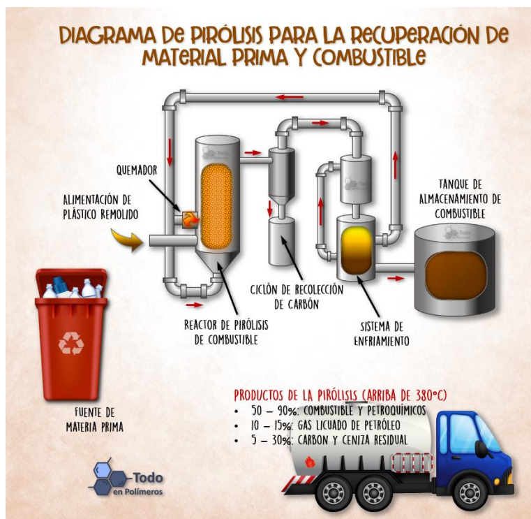
Figura 56 Diagrama de pirólisis para la recuperación de la materia prima
