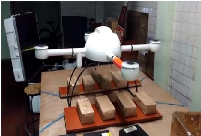
*Ilustración 69 Soporte de carga del Drone
