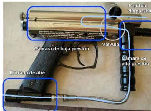
*Ilustración 56 Sistema neumático marcador de paintball*
