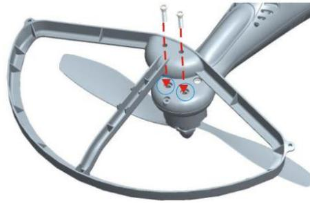
*Ilustración 46 Modelo de protector para hélices*
