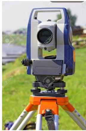
*Ilustración 40 Estación total electrónica, (123RF,2019)*
