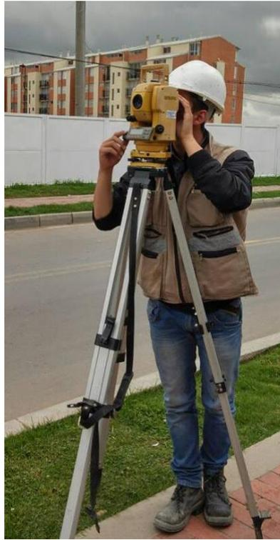
*Ilustración 30 Topografía con estación total
