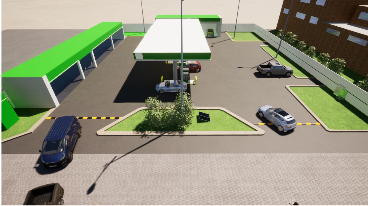
Figura 42. Ubicación reductores de velocidad. Fuente: Push Energy, 2020
