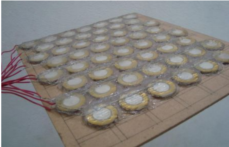
Figura 18. Elemento piezoeléctrico baldosa ensamblada. IPN (Instituto Politécnico Nacional) 2016.
