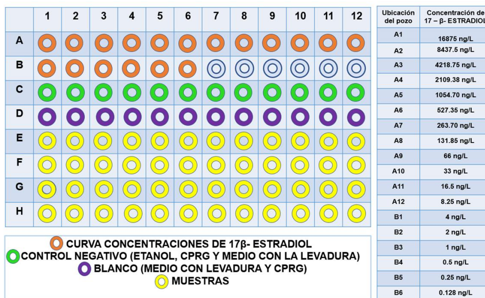
FIGURA 4. Disposición para el montaje en placas de ensayo. Ejecución de la curva control y muestras en microplaca para su respectivo análisis.
