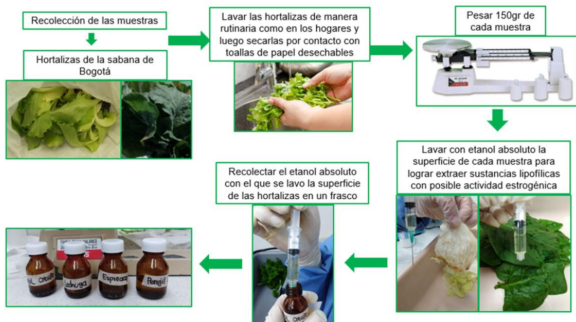
FIGURA 3. Procedimiento para la extracción de muestras problema. Técnica de lavado con etanol realizada en cada hortaliza.
