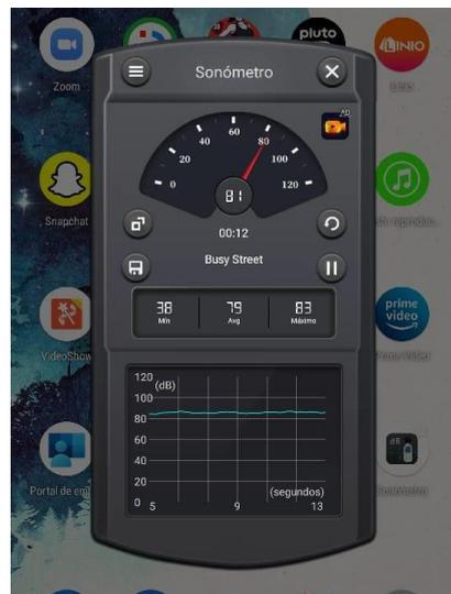
Se toma mediante la aplicación Sonómetro, los decibeles (dB) en los molinos y tornos, generadores principales de ruido.
