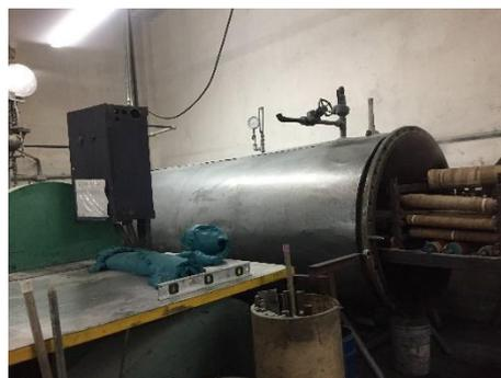
La caldera encargada de generar el vapor para la cocción de los rodillos se programa a 170°. Se deja actuar durante 3 horas y posteriormente se programa para des-compresionar la autoclave y que los rodillos se enfríen. Una vez completado este proceso, se sacan los rodillos de la autoclave y se dejan reposar para luego ser montados al torno uno por uno, para aplicar los siguientes pasos:
