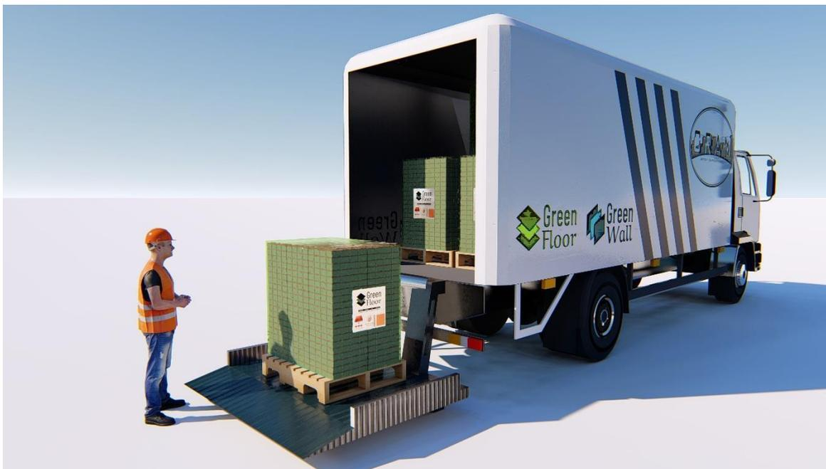
*Ilustración 81 Propuesta de descarga en camiones con plataforma hidráulica, elaboración propia*
