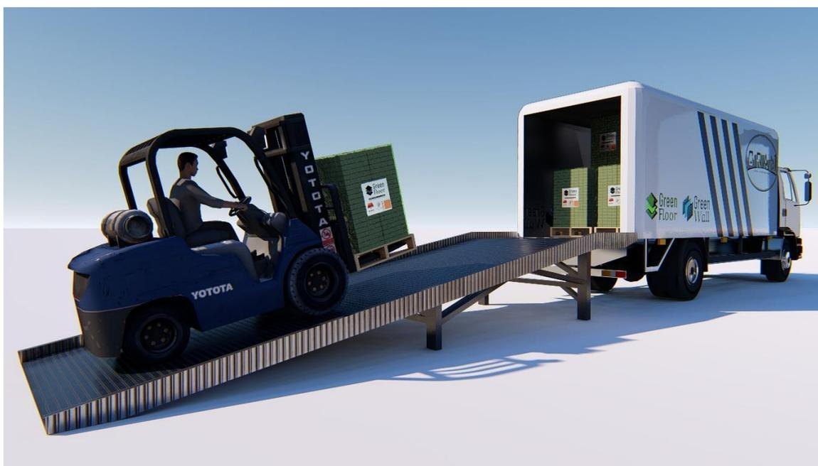
*Ilustración 80 Propuesta de cargue en camiones con plataforma y montacargas, elaboración propia*
