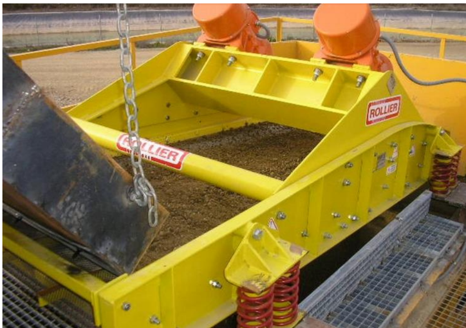
Fig. 20 Maquina Criba Vibrante
