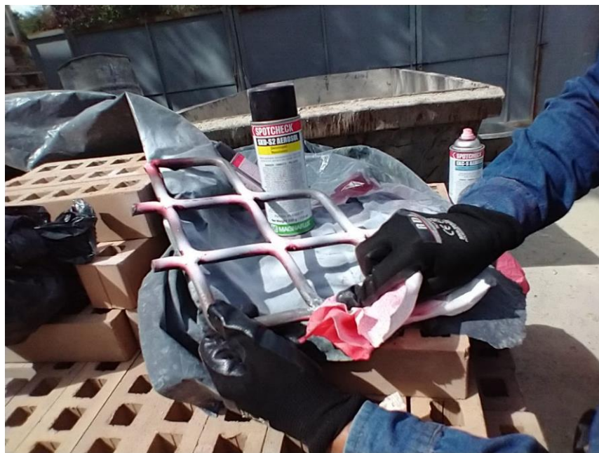
Fig. 38 Ensayo no Destructivo con Tintas Penetrantes
