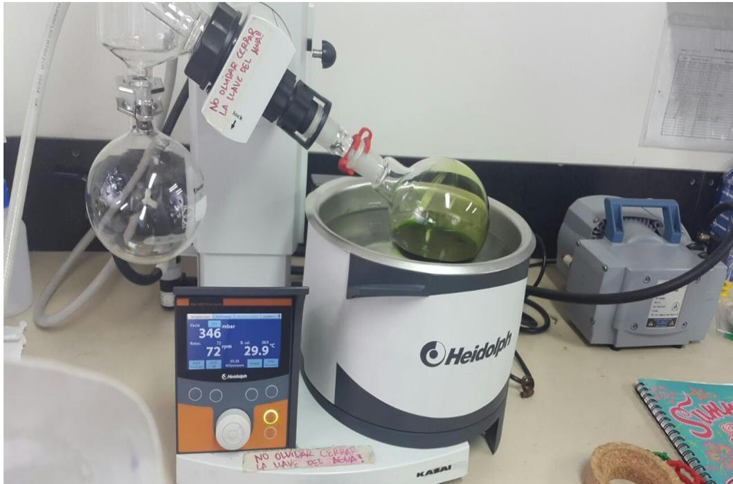
Figura 9. Concentración de filtrado del extracto de *Matricaria chamomilla* en rotoevaporador.
