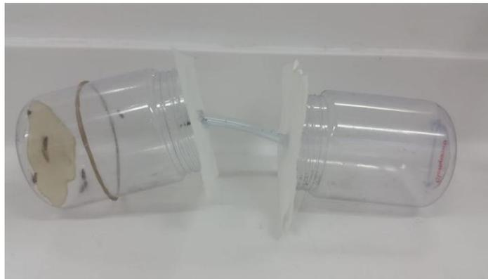
Figura 19. Olfatómetro para bioensayo de repelencia
