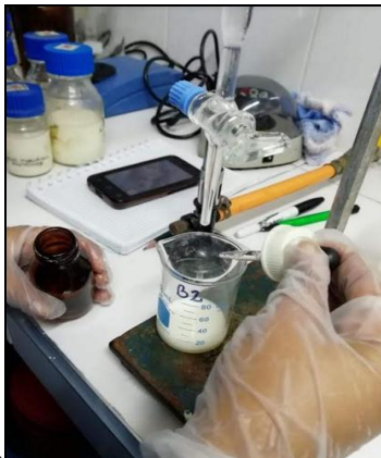
Figura 21. Titulación con Hidróxido de sodio, determinación de acidez
