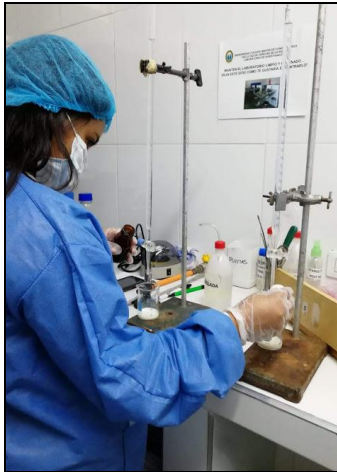
Figura 21. Titulación con Hidróxido de sodio, determinación de acidez
