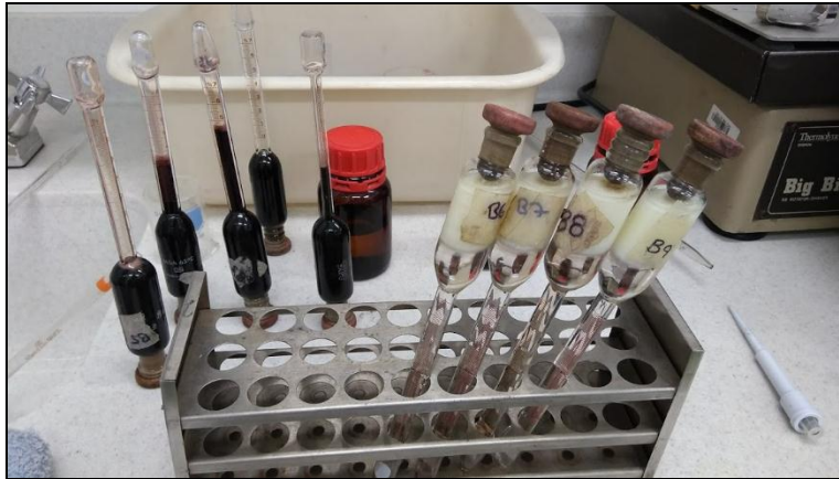
Figura 20. Método de gerber, butirómetro determinación de grasa.
