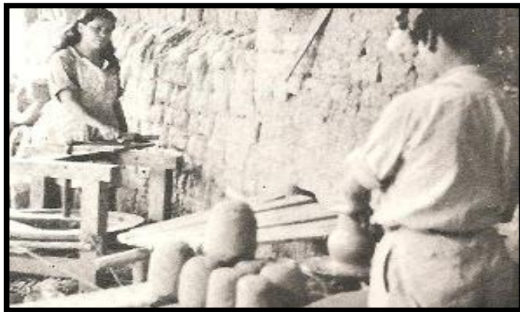
Imagen 10. Primeros tornos, impulsados con la ayuda de otra persona. Fuente: Mora de Jaramillo, Yolanda
