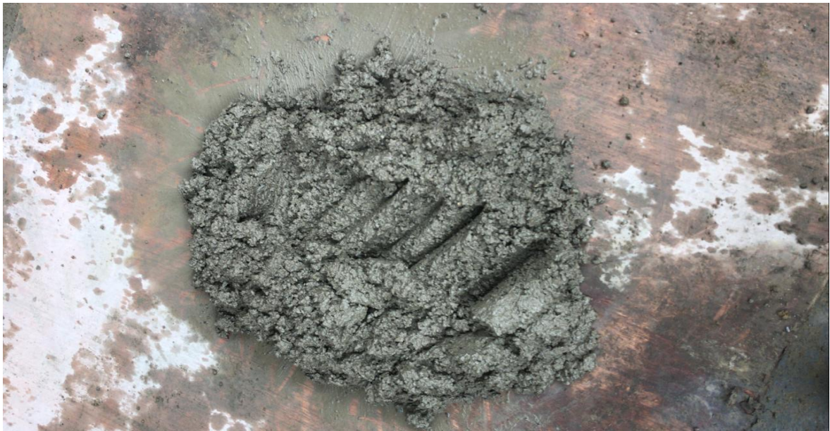
Figura 63 Mezcla concreto reciclado, arena, cemento blanco y agua, fuente propia 2021.
