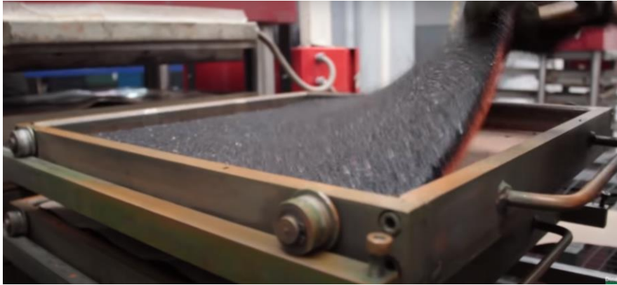
Figura 39 Proceso de desmolde, obtenido de (Gicomer, 2016)
