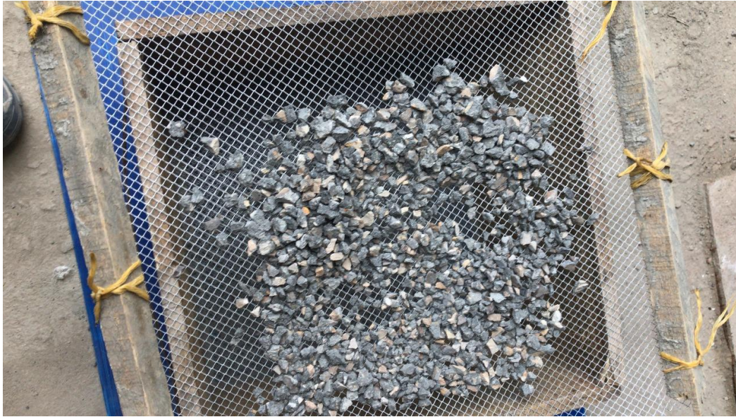
Figura 50 Tamizaje del concreto reciclado fuente propia 2021.
