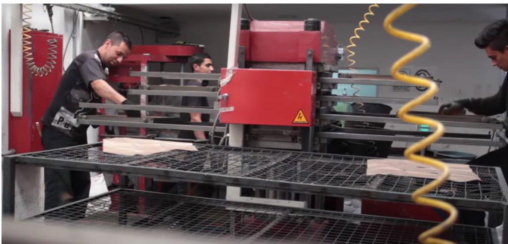
Figura 38 Proceso de horneado del triturado de llanta, obtenido de (Gicomer, 2016)
