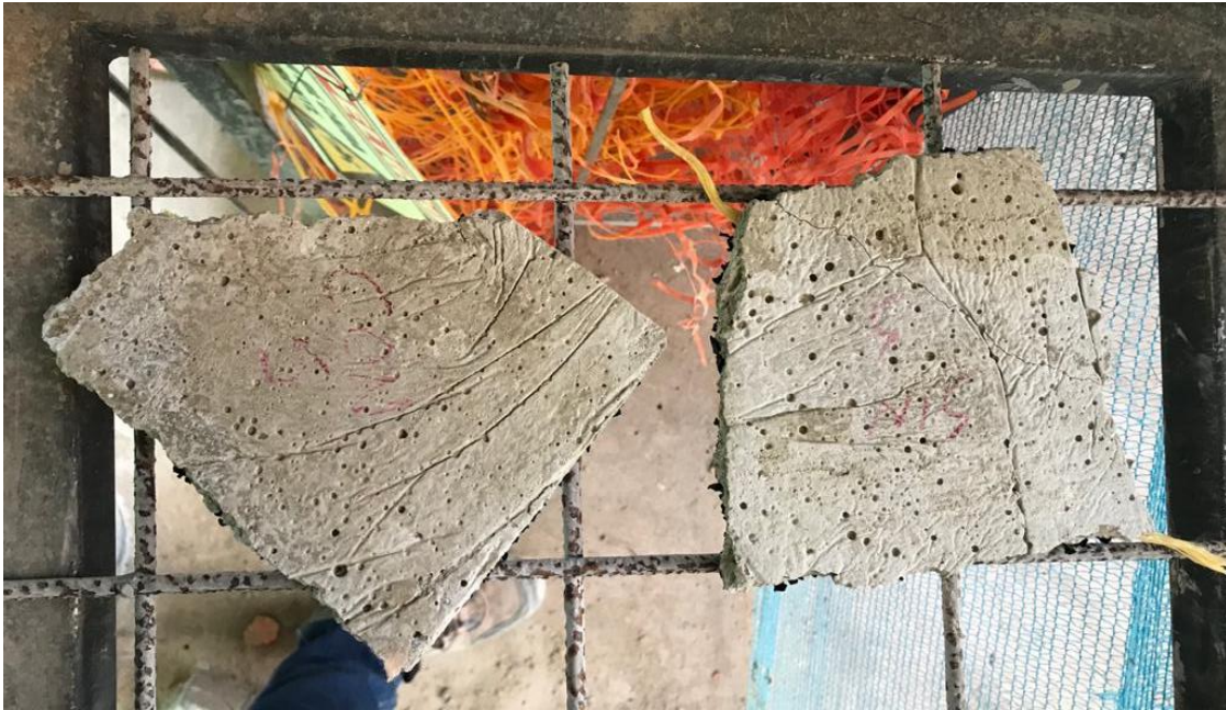
Figura 57 secado y desmolde de tableta fuente propia 2021.
