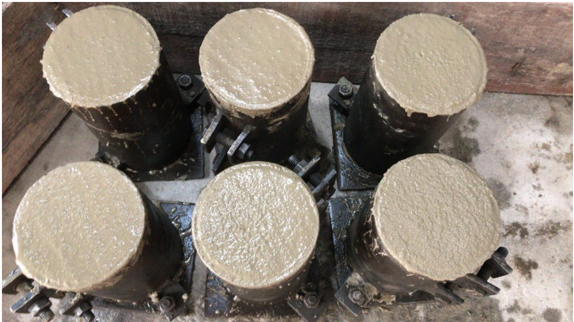
Figura 64 inserción de la mezcla en formaletas, Fuente propia 2021
