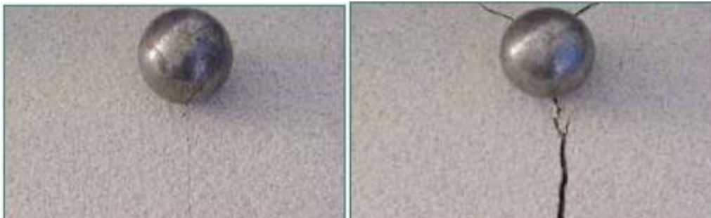
Figura 18 Ensayo de impacto, fisura provocada por el impacto del martinete (Construmática, 2021)
