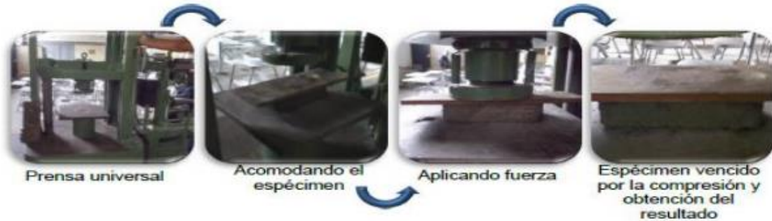
Figura 43. Prueba de resistencia a la compresión del ladrillo propuesto Fuente. Ángeles. 2015
