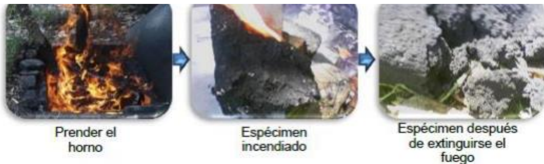
Figura 44. Ejecución de prueba a la flama de ladrillo con caucho Fuente. Ángeles. 2015
