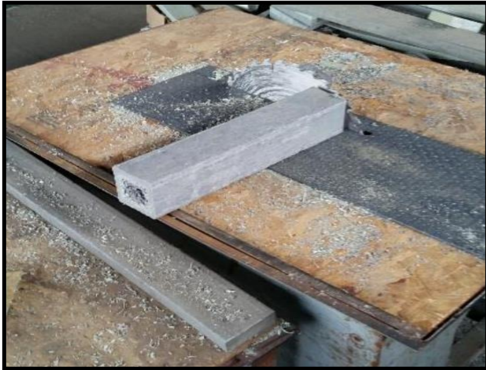
Figura 24. Prototipo de mampostería plástica. Fuente. Vargas García.2015
