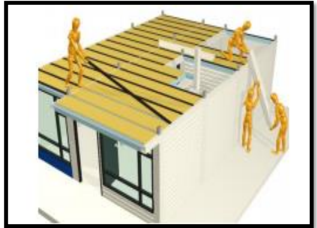
Figura 30. Instalación de loza entre piso. Fuente. Gómez Mahecha.2020
