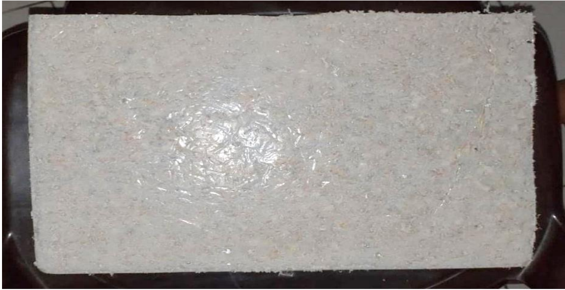
Figura 37. Panel de tetrabrik muestra 2. Fuente. Meléndez Rodriguez.2020
