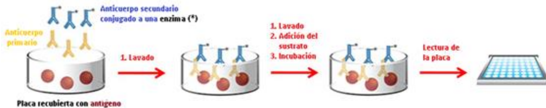
Figura 4. ELISA Indirecta. La placa de 96 pozos se recubre con antígenos específicos, los cuales son reconocidos por los anticuerpos presentes en los sueros de los pacientes. La unión se revela cuando se adiciona un anticuerpo anti-Fc humana conjugado con una enzima. Al agregar el sustrato de la enzima cambia de color el medio.
