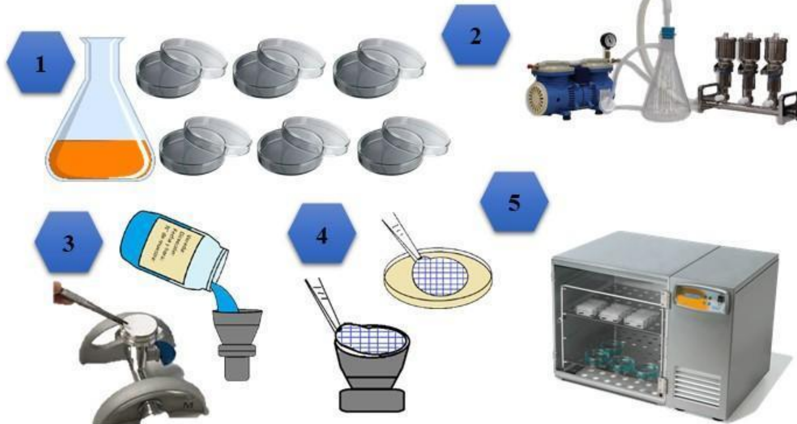
Figura 2. Análisis microbiológico utilizando filtración por membrana.
