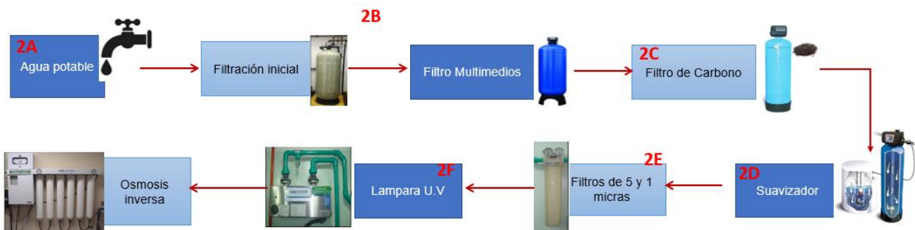
Figura 2. Esquema sistema de tratamiento de agua en la industria farmacéutica.
