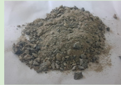
Concreto reciclado triturado
