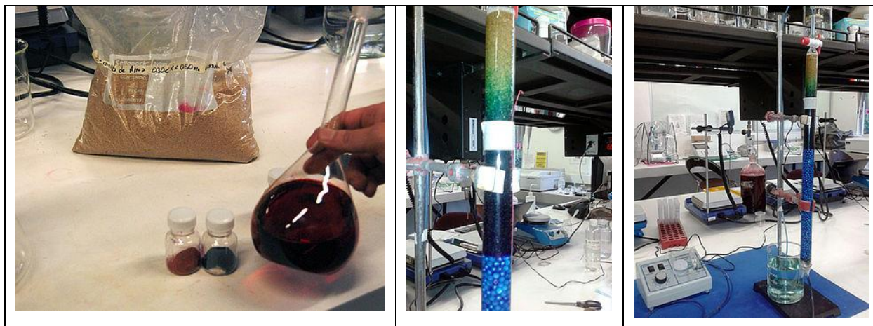
Ilustración 11, Cascarilla de arroz para remover colorantes Fuente: Agencia de Noticias UN julio 2014
