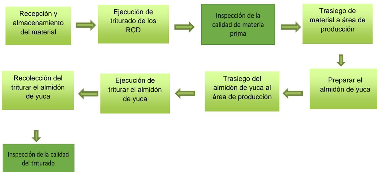
*Ilustración 17: Procedimiento sintetizado de elaboración de Eco-Mastik*
